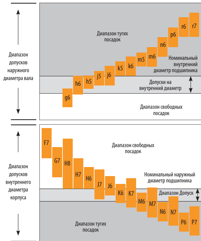
Рис. 5. Выбор посадки на вал и в корпус.
