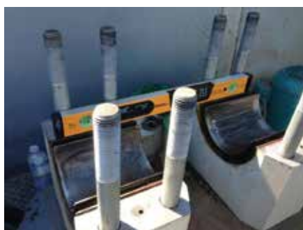
Figura 14: Medição do alinhamento do braço de torque
