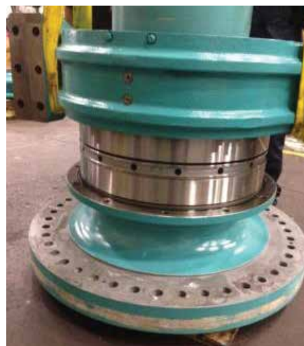
Figura 11: Instalação de mancal sobre TDI
